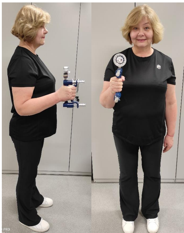
Rycina 9. Pomiar siły ścisku dłoni. Źródło: Opracowanie własne
