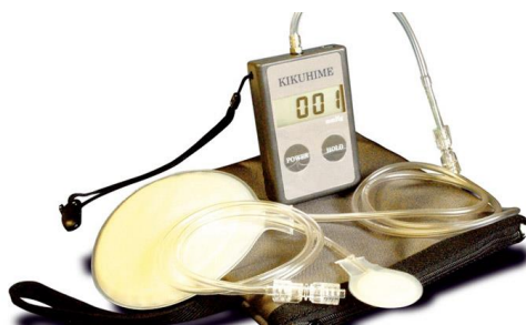
Rycina 6. Aparat Kikuhime - przenośne urządzenie służące do oceny i poprawności i pomiaru ciśnienia międzywarstwowego w przypadku stosowania terapii kompresyjnej [70].
