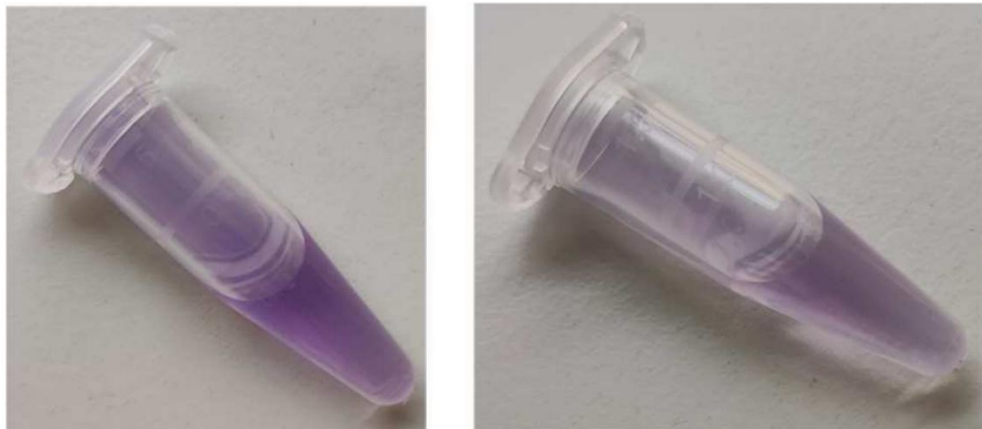
Rysunek 2. Kolory powstałe w wyniku reakcji BSA (10 mg/mL) z ABTS • (107 \mu M), z lewej, oraz reakcji tyrozyny (2 mM) z ABTS • (107 \mu M), z prawej. Objętość reakcji: 1 mL, czas reakcji: 1 godzina [badania własne, publikacja 3].
