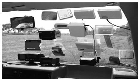
Rysunek 3. Urządzenia pokładowe OBU aktualnie stosowane w pojeździe
