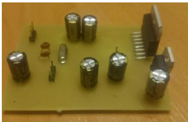
Rys. 13 Układ umożliwiający sterowanie taśmociągiem ( prędkości obrotowej taśmy).
