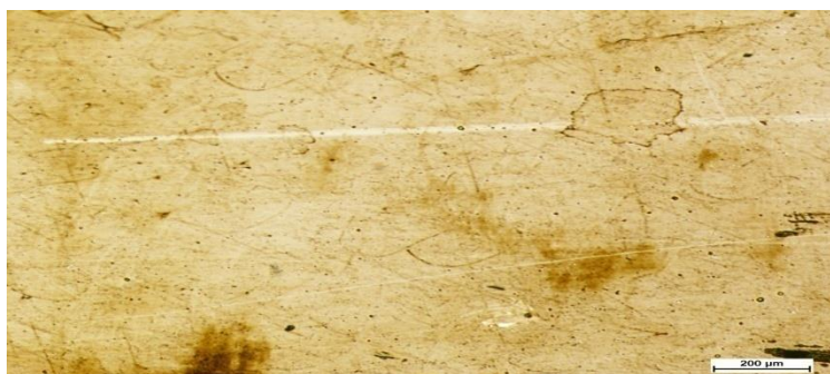
Rys. 11. Obraz z mikroskopu optycznego rysy 1 próbki TiO 2 Cu 2 O na szkle przy powiększeniu 50x
