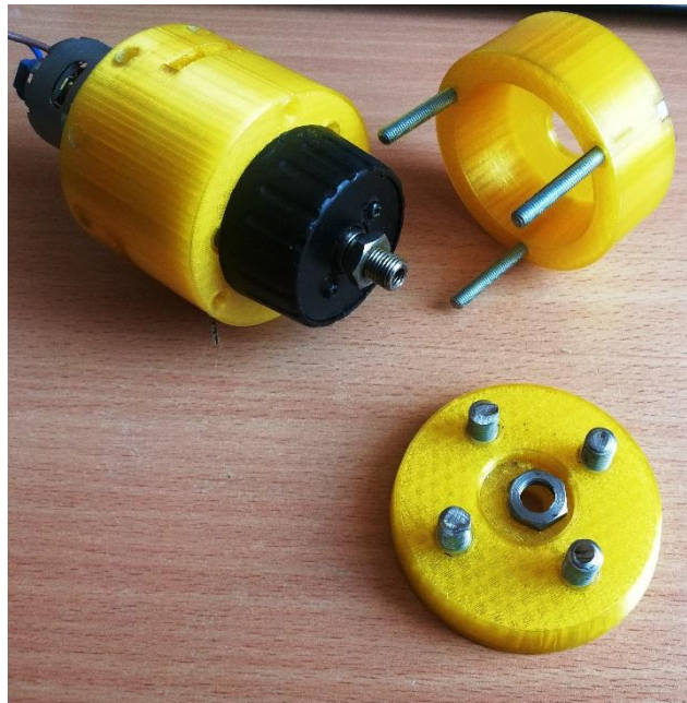
Rys. 3. Zespół przekładni planetarnej zamontowany w adapterze [opracowanie własne]
