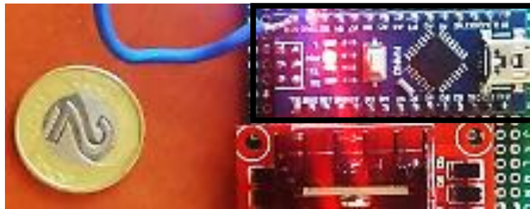
Rys. 5. Układ sterowania ATmega238P na płycie Arduino Nano (zaznaczony czarną obwiednią) [opracowanie własne]
