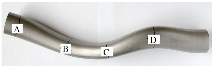
Rys. 3. Analizowany Dedal uzyskany technologią hydromechaniczną (~1m długości)
