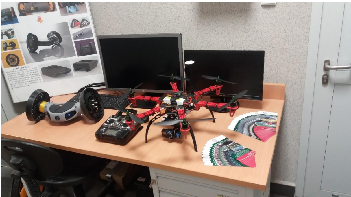
Rys. 4. Jednoosiowy robot rozpoznawczy wraz z bezzałogową platformą wsparcia z powietrza [opracowanie własne]
