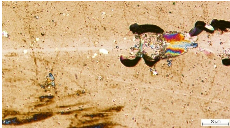
Rys. 13. Obraz z mikroskopu optycznego rysy 3 próbki \text{TiO}_2\text{Cu}_2\text{O} na szkłe przy powiększeniu 50x
