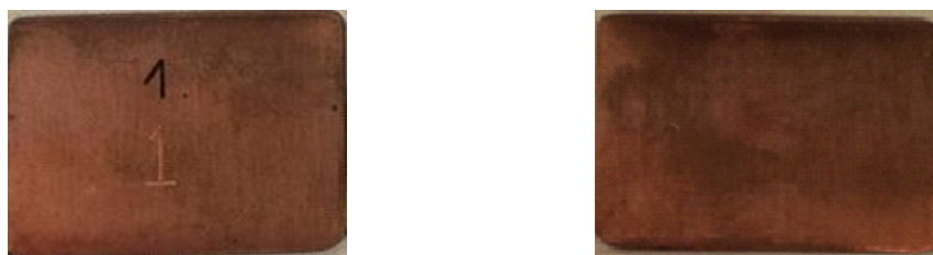
Rys 2. Próbkę stopu miedzi a) przed mechanicznym usunięciem tlenków, b) po mechanicznym usunięciu tlenków
