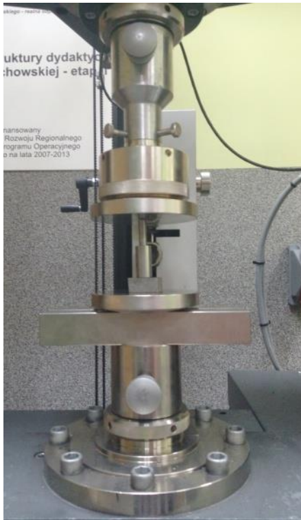
Rys. 3. Schemat próby ściskania ostrzy stalowych
