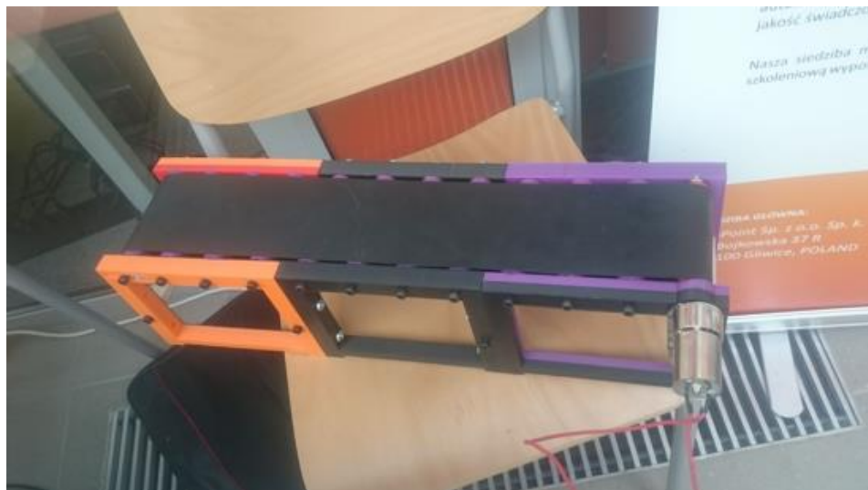
Rys.6 Wydrukowany taśmociąg, z założoną taśmą.
