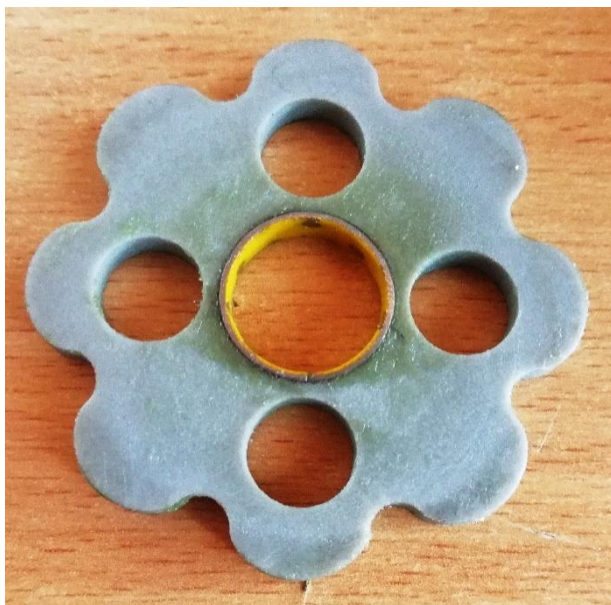
Rys. 5. Koło cykloidalne przekładni wytworzone przy użyciu techniki przyrostowej SLS [opracowanie własne]
