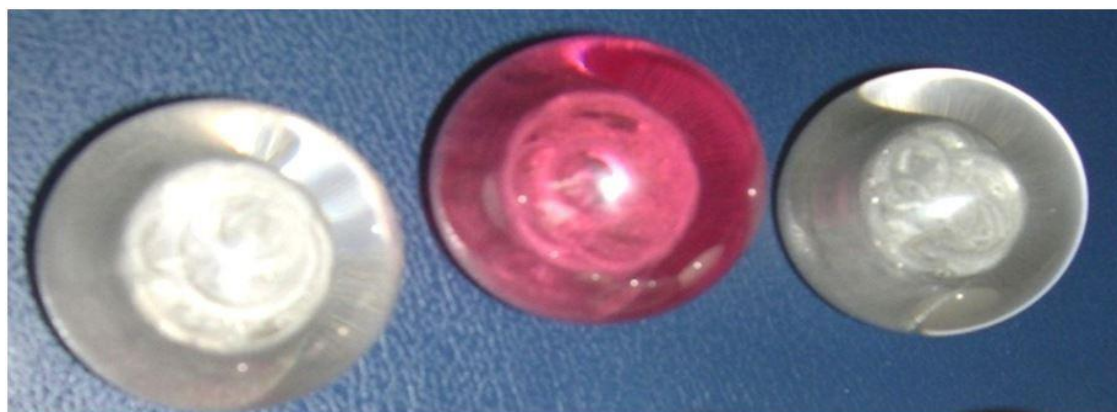
Rys. 37. Głowy szafirowe sztucznych stawów biodrowych o średnicy 32 mm Ze zbiorów prof. A. Rosenberga z Instytutu Materiałów Supertwardych w Kijowie
