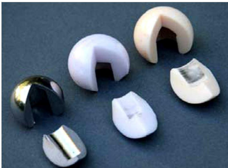
Rys. 39. Głowy endoprotez wykonane z różnych materiałów (po stronie lewej ze stopu vitalium, pośrodku z cyrkonu, po stronie prawej z korundu) z otworami w głowach o różnej głębokości służących do osadzenia sworznia trzpienia.
