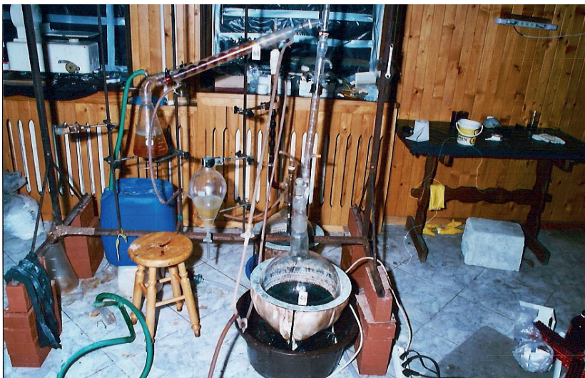
Fot. 10. Przykład nielegalnego laboratorium (proces destylacji substancji)
