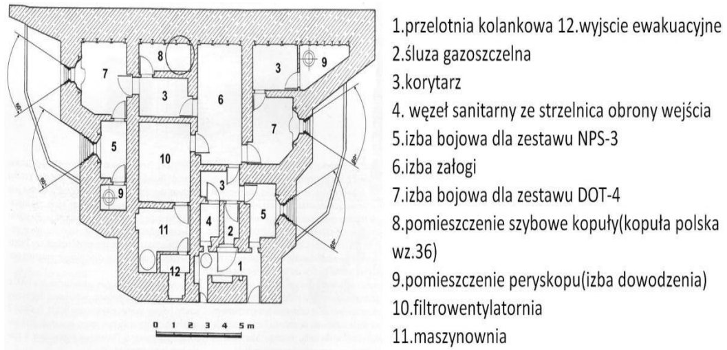
Rysunek 11. Schemat schronu typu OPK z P.O. Przemysł
