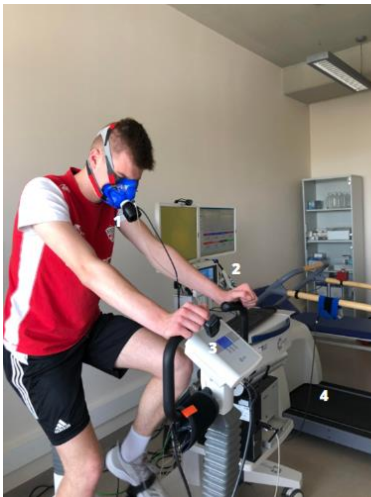
Ryc. 4 Ergospirometr wraz z urządzeniami peryferyjnymi: maska wraz z turbiną oraz drenem (1), Spiroergometr (2), Cykloergometr (3), Bieżnia (4) (Opracowanie własne).
