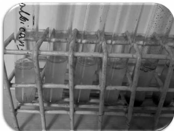
Rys. 8. Zdjęcie proszków nanodiamentowych zmodyfikowanych chemicznie Fentonem oraz z przyłączoną ampicyliną po 20 dniach hodowli ze szczepem Candida albicans
