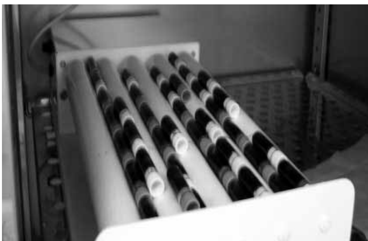
Rys. 2. Układ badawczy składający się z mieszadła rolkowego hematologicznego, umieszczony w ciepłarnie
