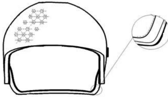
Rys. 9. Schematyczne przedstawienie budowy kasku
