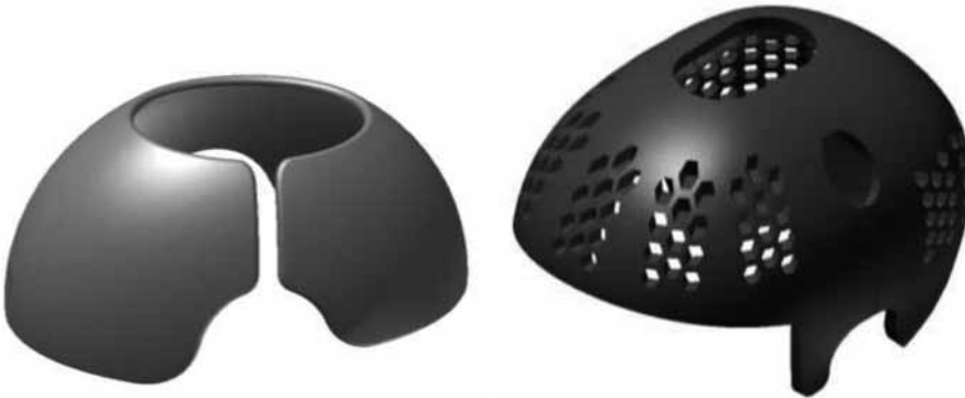
Rys. 6. Koncepcja konstrukcji korpusu kasku przed i po optymalizacji
