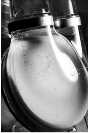
Rys. 15. Proteza ReligaHeart EXT po 30 dniach stosowania w badaniach doświadczalnych na zwierzętach. Widoczne drobne, punktowe skrzeplinki, zadherowane do powierzchni czaszy krwistej w obszarze sąsiadującym z konektorem wypływowym
