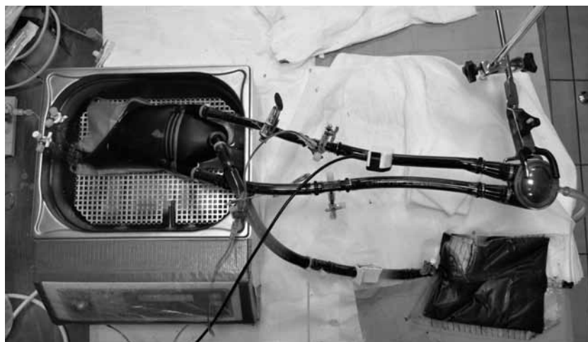
Rys. 9. Stanowisko krążenia krwi stosowane w badaniach metodą ostrej trombogenności
