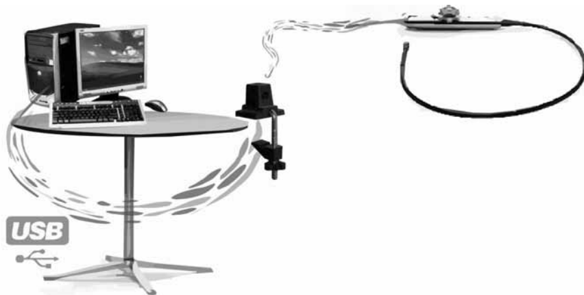
Rys. 6. Połączenie urządzenia symulatora z programem CT2TEE
