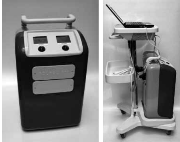
Rys. 12. Przenośny, pneumatyczny sterownik protez serca ReligaHeart PDU-501 (po lewej) oraz umieszczony na wózku sterownik wraz z komputerem zdalnego nadzoru (po prawej)
