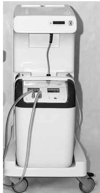
Rys. 13. Hybrydowy sterownik typu ReligaHeart PDU-DUO: widoczna jednostka przenośna umieszczona na stacji dokującej
