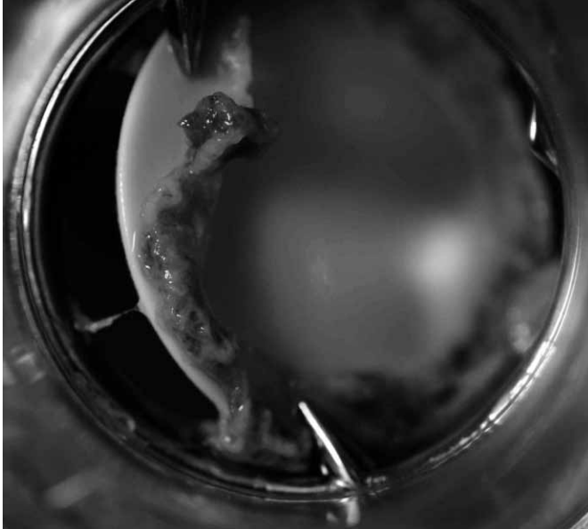
Rys. 10. Wynik metody ostrej trombogenności – widoczna skrzepina przyklejona do krawędzi dysku i listka zastawki o wadliwym wykończeniu powierzchni
