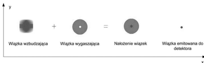
Ryc. 4. Mechanizm oświetlania fluorochloru w STED
