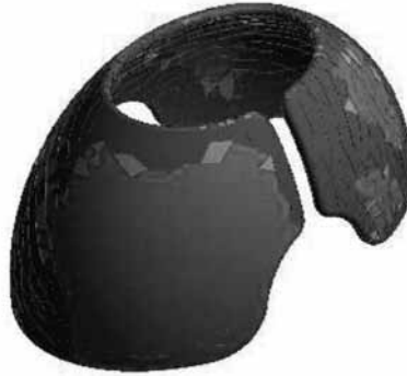
Rys. 5. Wynik optymalizacji masy kasku, kolor pomarańczowy ilustruje elementy, które można zredukować
