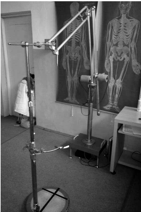
Rys. 5. Urządzenie Posturometr S ze stabilizatorem w płaszczyźnie strzałkowej i czołowej
