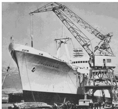
Fot. 37. SPPR „Paderewski”, zbudowany w 1960 r. drobnicowiec typu Split, długość 152,8 m, silnik Fiat 1 SD6 zapewniał prędkość 15 węzłów, wyposażony w 5 ładowni częściowo chłodzonych. Dnia 1 stycznia 1976 r. przekazany nieodpłatnie przez Polskie Linie Oceaniczne ChPTO – Chipolbrot – Chińsko-Polskiemu Towarzystwu Okrętowemu w Szanghaju SA. Oddany na złom w 1986 r. Źródło: Zygmunt Stoberski, Jugosławia , Warszawa 1966, s. 81.
